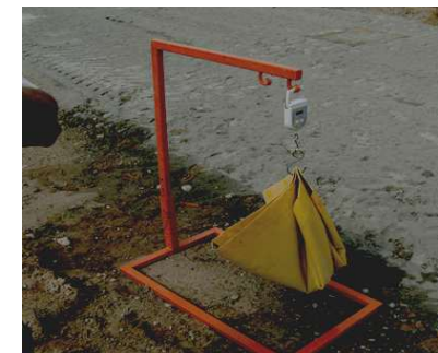
Ważenie tacki pomiarowej ze spoiwem
